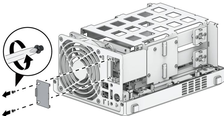
7. 卸下将另一个 PCIe 扩充防护罩上固定到位的四颗螺丝，然后卸下防护罩。
