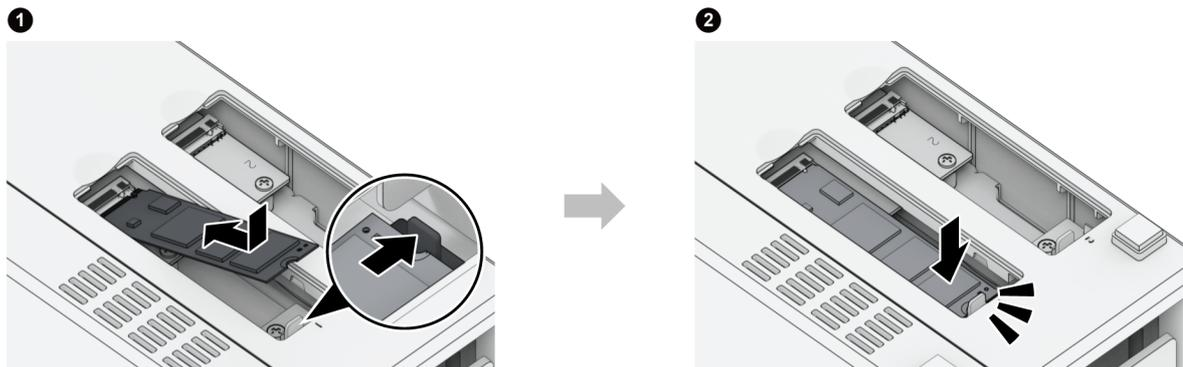
5. 如果需要，请重复上述步骤，将第二个 SSD 模块安装到第二个插槽中。
