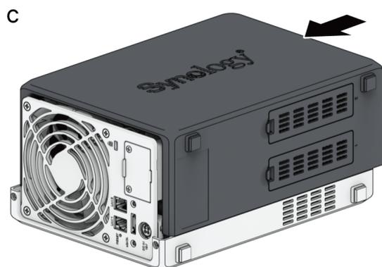
7. 重新安装固定后面板的螺丝。
