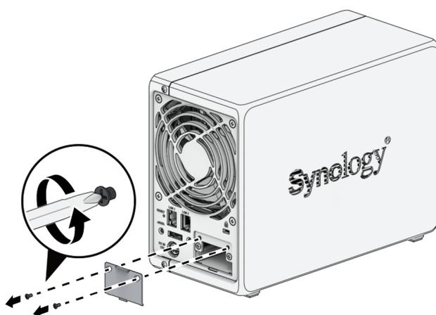
3. 插入网络升级模块并拧紧两颗螺丝以固定新插入的模块。
