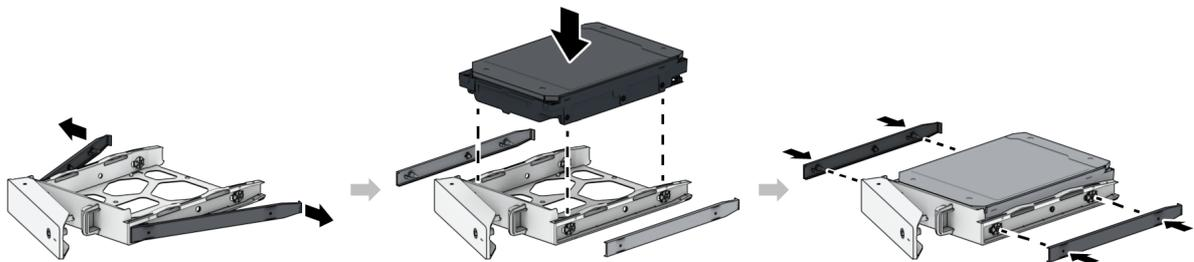
4. 对于 2.5 英寸硬盘：卸下托盘侧面的紧固板并存放在安全的地方。将硬盘放入如下所示的硬盘托盘区域，将托盘翻转朝下，然后拧紧提供的螺丝来将硬盘固定到位。
