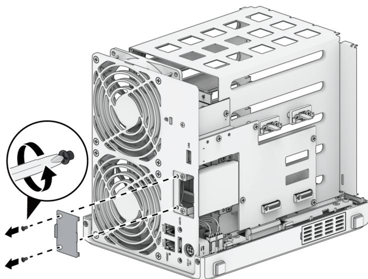
7. 卸下将另一个 PCIe 扩充防护罩上固定到位的四颗螺丝，然后卸下防护罩。
