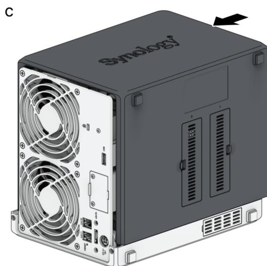
7. 重新安装固定后面板的螺丝。
