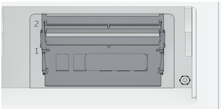
4. 向外推动内存模块两侧的退出杆。内存模块将从其插槽中释放。
