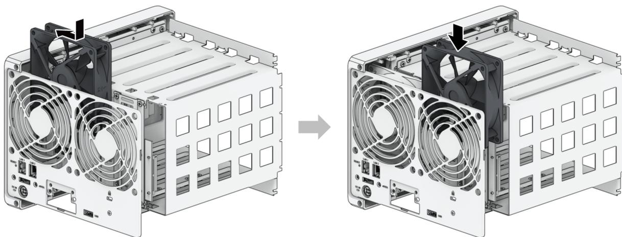
3. 安装背板螺丝并在对应的插槽中连接风扇接头，如下所示。
