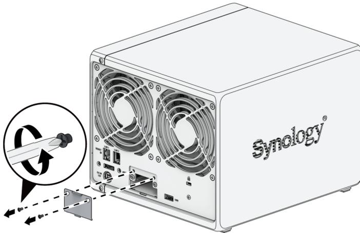
3. 插入网络升级模块并拧紧两颗螺丝以固定新插入的模块。
