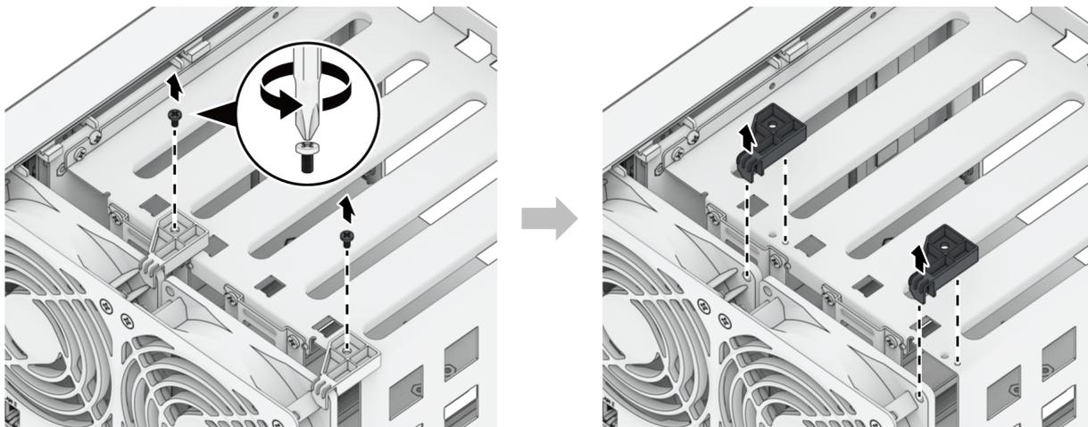
6. 卸下 Synology NAS 背面风扇下方的两颗螺丝以及 PCIe 扩充防护罩。
