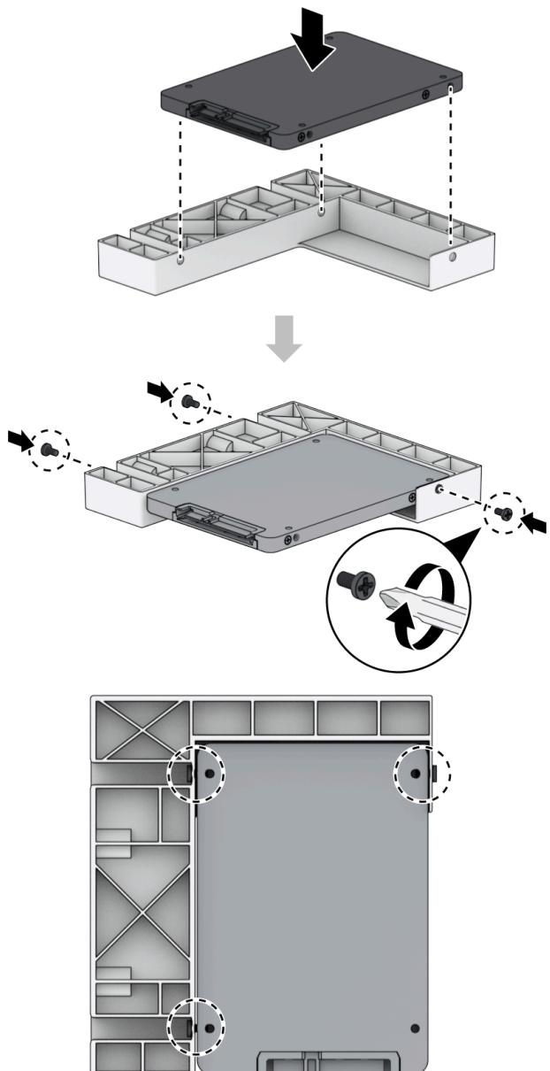
b. 将 2.5 英寸硬盘托架滑入硬盘插槽，并将其推入直至与 SATA 接头稳固连接。请使用提供的螺丝来固定硬盘托架。
