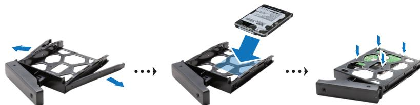
4 將裝好的硬碟托盤放入空的硬碟插槽。
