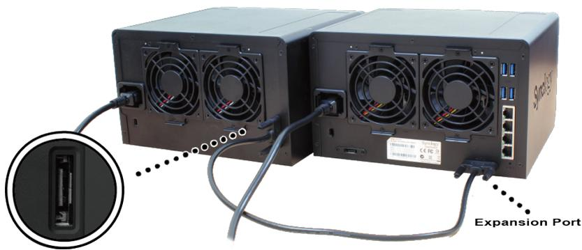
接続が完了した後では、接続された DiskStation の電源がオン・オフになると、DX517 は自動的にオン / オフに切り替わります。
