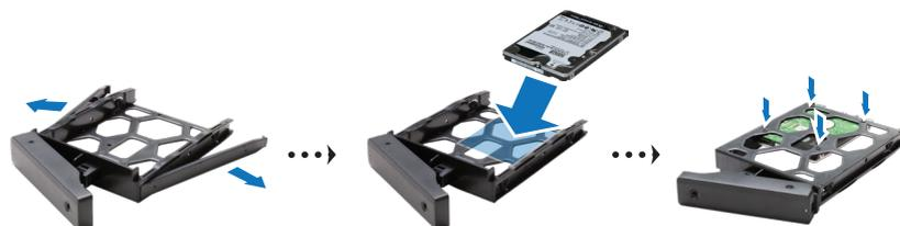
4 ドライブを載せたドライブトレイを空のドライブベイに挿入します。
