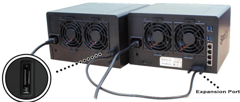
Después de finalizar conexión, el DX517 se activará o desactivará automáticamente cuando la DiskStation conectada se encienda o se apague.
