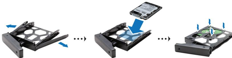
**4** Inserte la bandeja de discos cargada en el receptáculo de unidades vacío.
