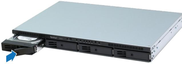
**注意：**請確定已將托盤完全推入。否則，硬碟可能無法正確運作。
