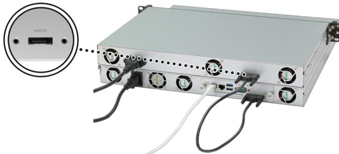
連接完成後，當您開啟 / 關閉 RackStation 主機的電源時，連接正確的擴充裝置會自動開啟 / 關閉電源。
