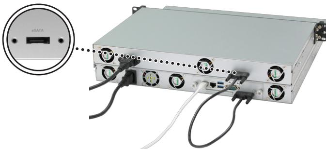
Nachdem die Verbindung hergestellt wurde, wird die Expansionseinheit automatisch mit der angeschlossenen RackStation ein- bzw. ausgeschaltet.
