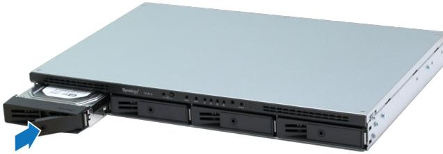
**Anmerkung:** Achten Sie darauf, dass der Einschub vollständig hineingeschoben ist. Ansonsten funktioniert das Laufwerk möglicherweise nicht korrekt.
