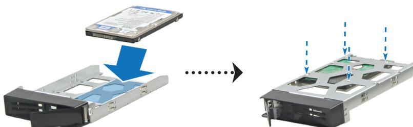
3 Setzen Sie den Laufwerkträger mit dem Laufwerk in den leeren Festplattenschacht ein.
