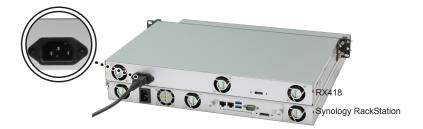
2 Conecte uma extremidade do cabo de expansão à unidade de expansão, e a outra à unidade principal do RackStation.
