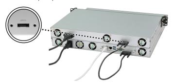
Depois de concluída a ligação, a unidade de expansão será ligada ou desligada quando a RackStation associada é ligada ou desligada.
