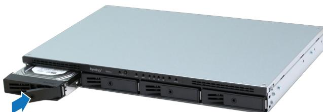
**Примечание.** Убедитесь, что лоток задвинут до упора. В противном случае в работе диска могут возникнуть неполадки.
