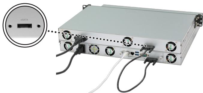
После подключения модуль расширения будет включаться и отключаться автоматически при включении или отключении RackStation.
