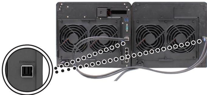
Wenn die Geräte verbunden sind, schaltet sich DX1222 automatisch ein und aus, wenn der angeschlossene NAS herunter- oder hochfährt.
