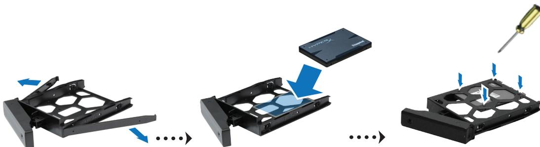
4 Setzen Sie den Festplattenträger mit der Festplatte in den leeren Einschub ein und schieben Sie ihn mit der oberen Hälfte des Griffs in die passende Position.
