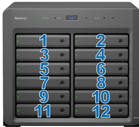
**Anmerkung:** Für die Einrichtung eines RAID-Volumens wird empfohlen, Laufwerke mit gleicher Größe zu installieren, um ihre Kapazität optimal auszunutzen.
