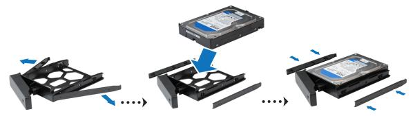
• Per unità da 2,5": Rimuovere i pannelli di serraggio dai lati del vano unità e riporli in un luogo sicuro. Posizionare l'unità nell'area del vano unità indicata da un rettangolo blu sottostante. Capovolgere il cassetto e stringere le viti per fissare l'unità in posizione.
