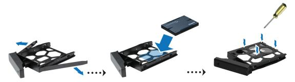
4 Inserire il vano del disco rigido caricato nell'alloggiamento del disco rigido vuoto e spingerlo in posizione mediante metà superiore della maniglia.
