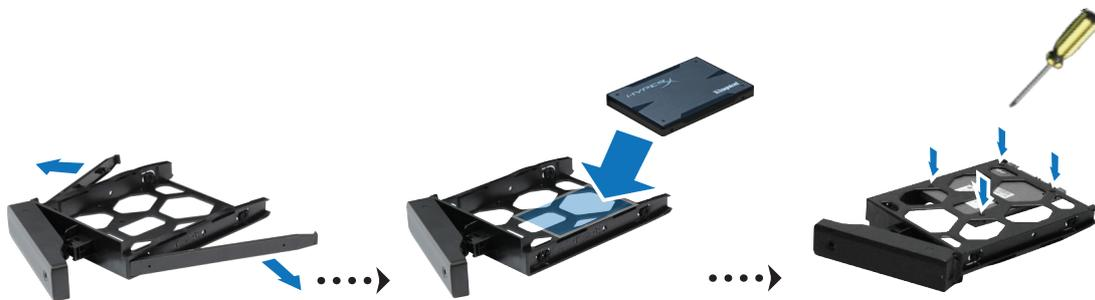
**4** Insira o tabuleiro carregado com o disco rígido no compartimento do disco rígido vazio e coloque-o na posição correta, empurrando a metade superior do manipulador.
