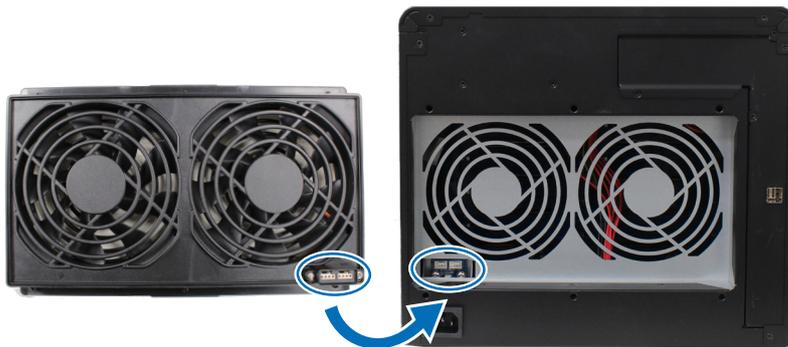
**b** Перед тем как поместить новый модуль в Synology NAS, убедитесь, что все 6 креплений выдвинуты наружу. После установки модуля верните их в прежнее положение, чтобы зафиксировать модуль вентилятора.
