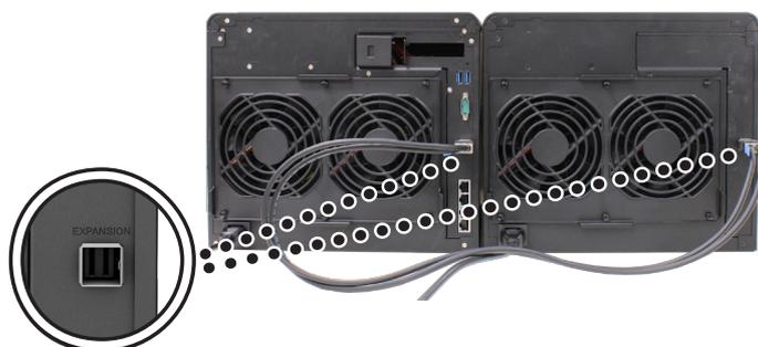
После подключения DX1222 будет включаться и отключаться автоматически при включении или отключении NAS.
