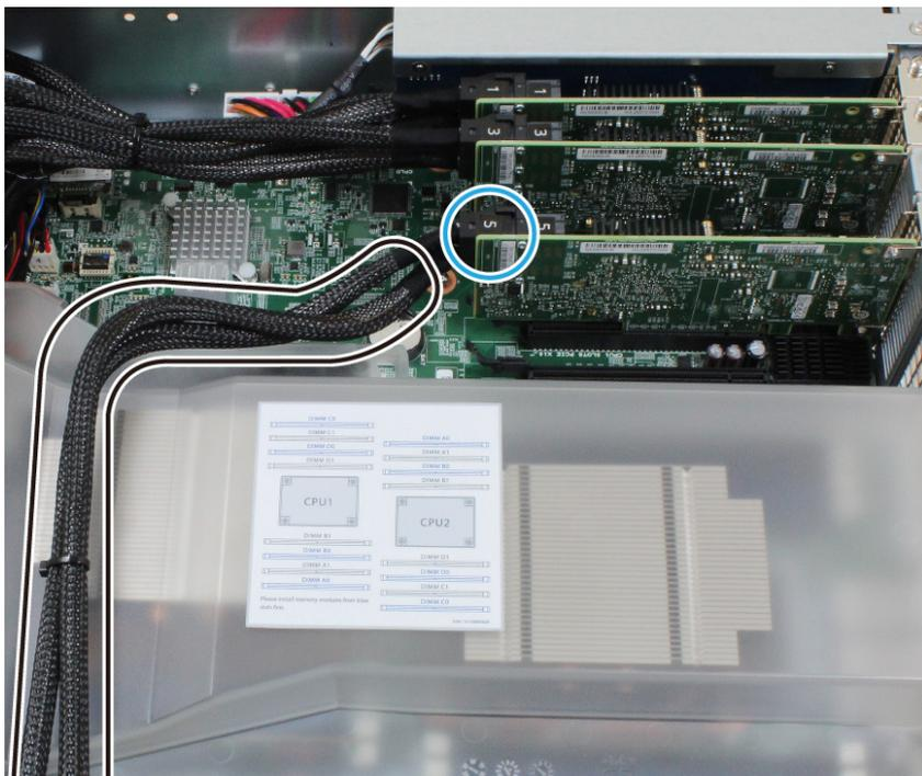
5 卸下 3 颗固定通风槽盖的螺丝，移开通风槽盖，放在一边。
