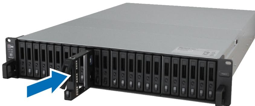
**注：**请确定已将托盘完全推入。否则，硬盘可能无法正常工作。
