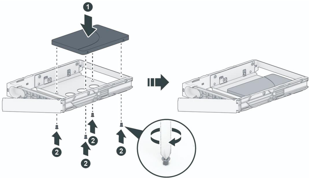
。对于 3.5 英寸硬盘：将硬盘置于硬盘托盘中。
