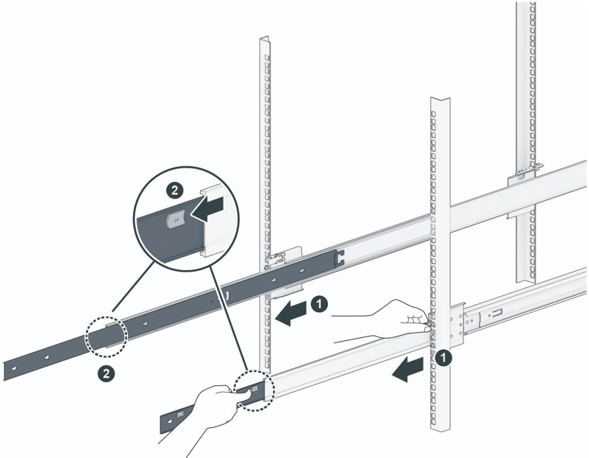
3. 将导轨套件连接到 Synology NAS :
