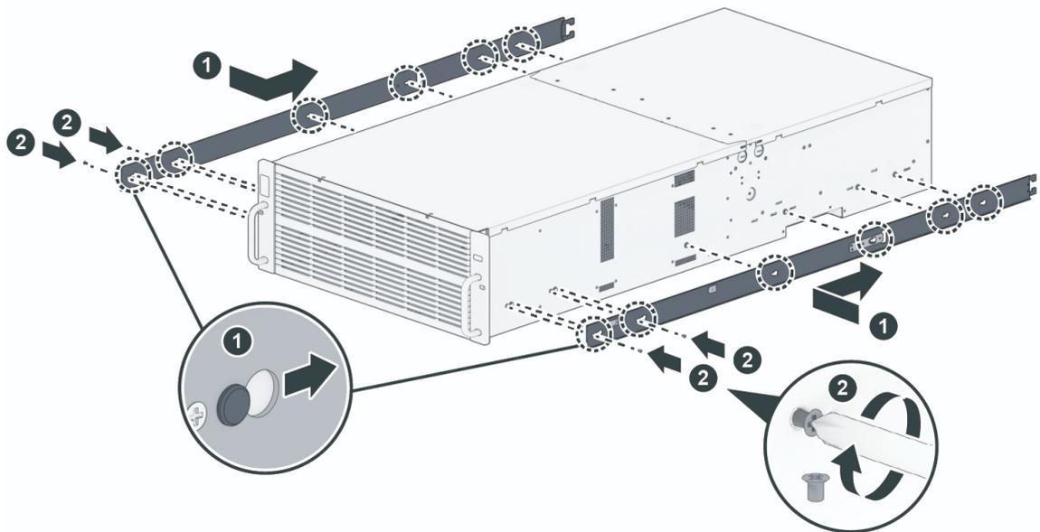
4. 在他的帮助下，小心地将内部导轨与外部导轨组件对齐，然后将机箱推向机架。
