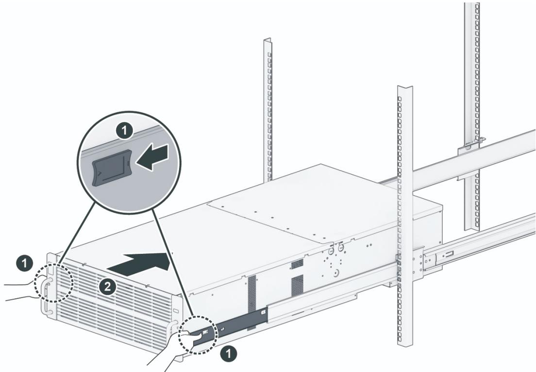
6. 将机箱推入机架末端，然后使用 4U 螺丝将机箱固定到机架上。
