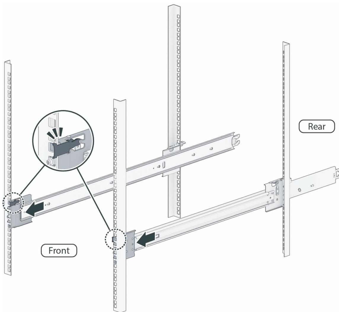
c. 固定导轨螺丝并安装锁紧螺母，如图所示。
