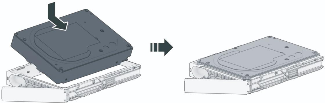
4. 将装好硬盘的托盘置入空的硬盘插槽。
