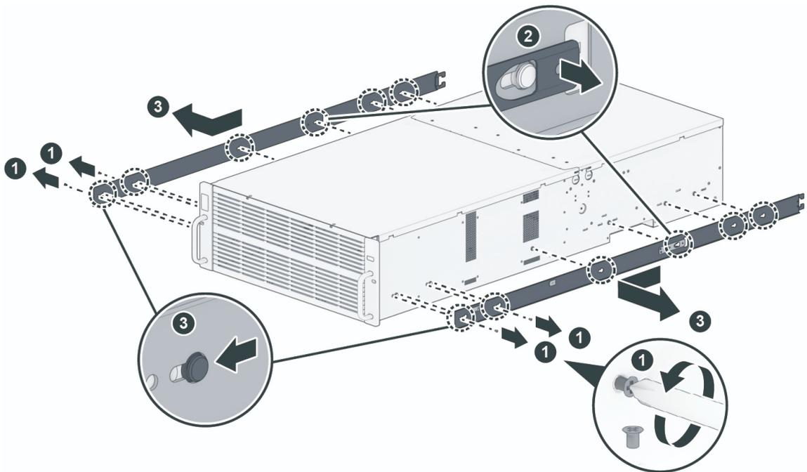
5. 如图所示，握住内部导轨上的后卡榫，然后继续将内部导轨推回到组件。
