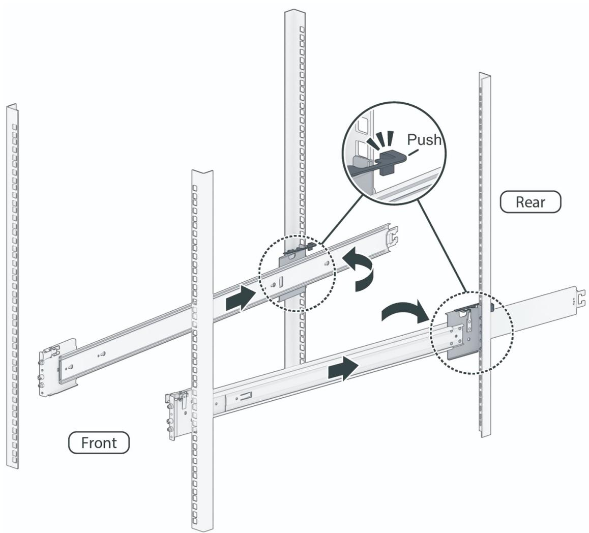
b. 向外滑动前卡榫，然后将支架插入机架孔中。
