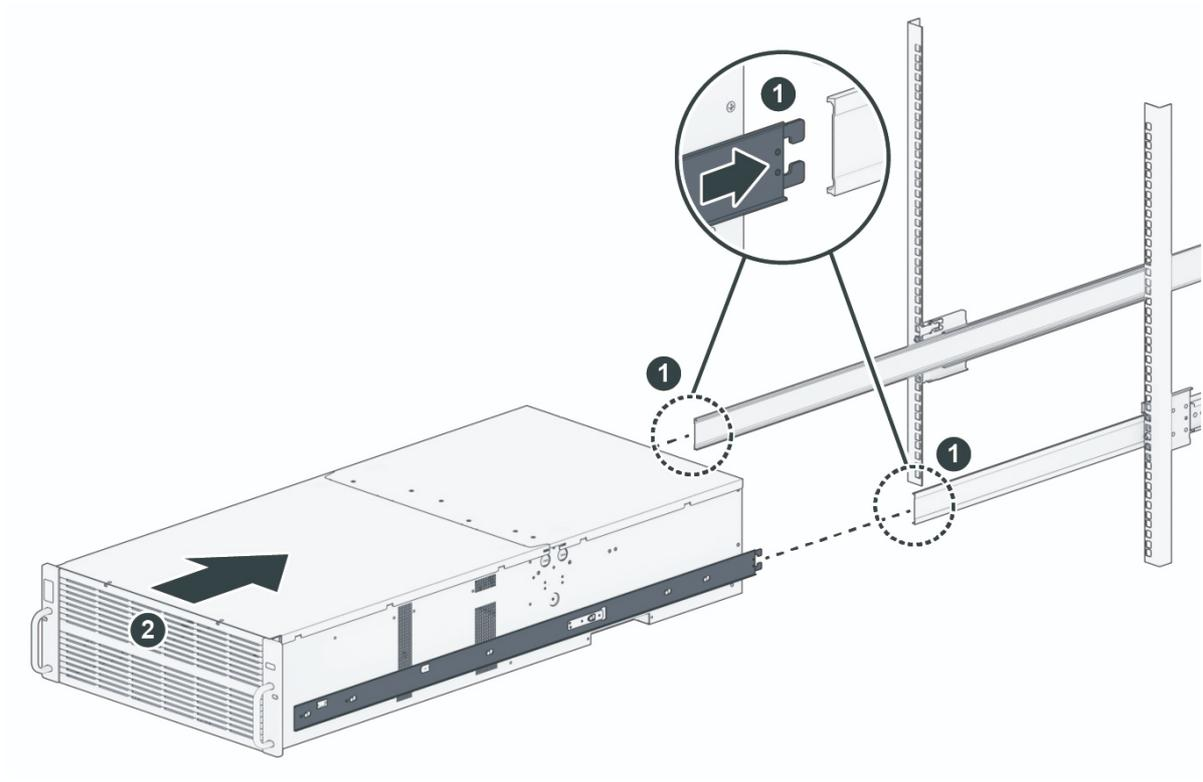
5. 如图所示，拉动内部导轨的前卡榫以解锁内部导轨，并继续将机箱推向机架。
