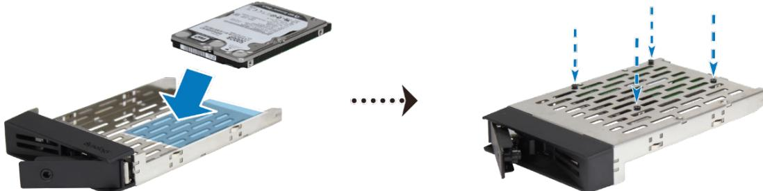
**3** 将装好硬盘的托盘放入空的硬盘插槽。
