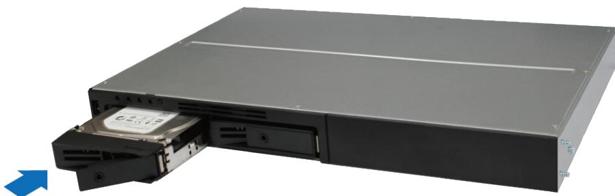
**注：**请确定硬盘托架已完全推入。否则，硬盘可能无法正确运作。
