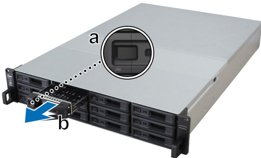
a 找到硬盘托盘把手左侧的小按钮。按下按钮，硬盘托盘把手将弹出。
