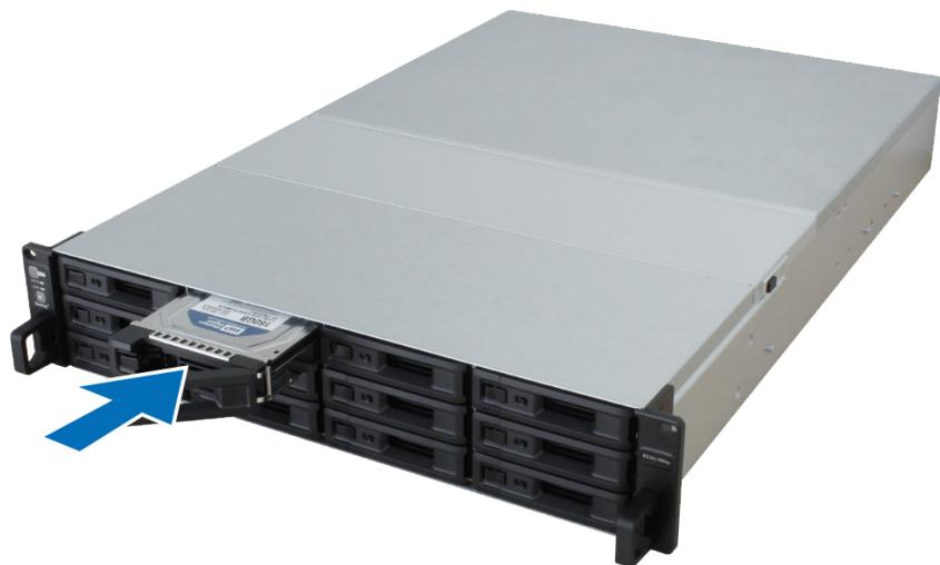
**注：**请确定已将托盘完全推入。否则，硬盘可能无法正常运作。
