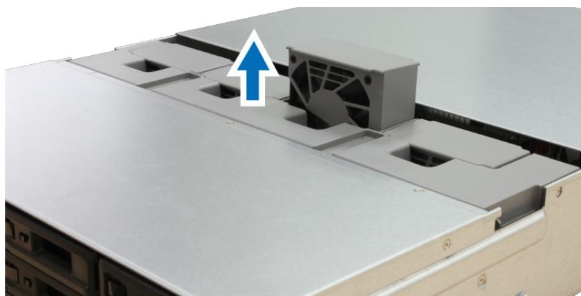
5 准备新风扇，并将其滑入 RackStation。确认风扇按如图所示正确对齐。
