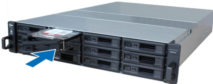
**注意：**请确定硬盘托盘已完全推入。否则，硬盘可能无法正常工作。
