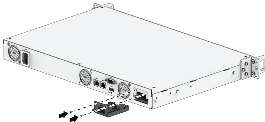
**注意：**确认网络升级模块已完全插入。否则，网络升级模块可能无法正常工作。
