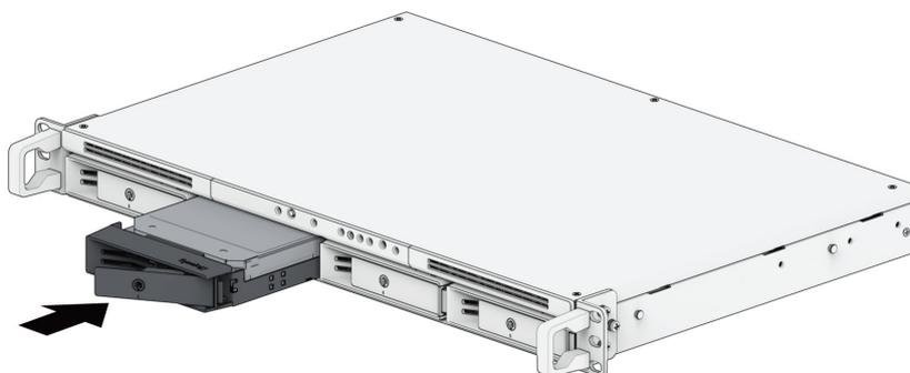
**注意：**请确定硬盘托盘已完全推入。否则，硬盘可能无法正常工作。
