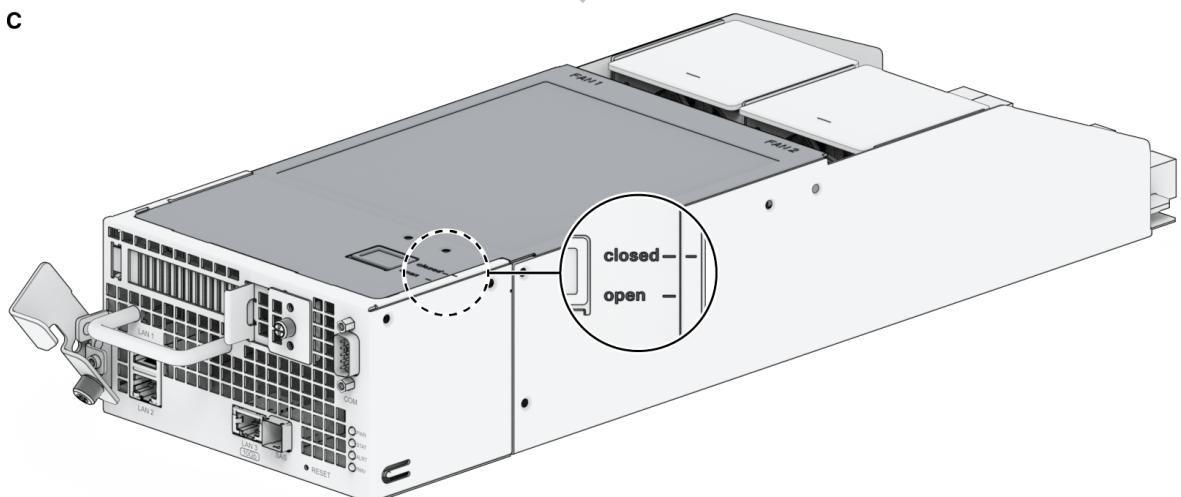
8. 将控制器重新插入到 Synology NAS 中。推回释放杆并顺时针旋转螺丝以固定控制器。
