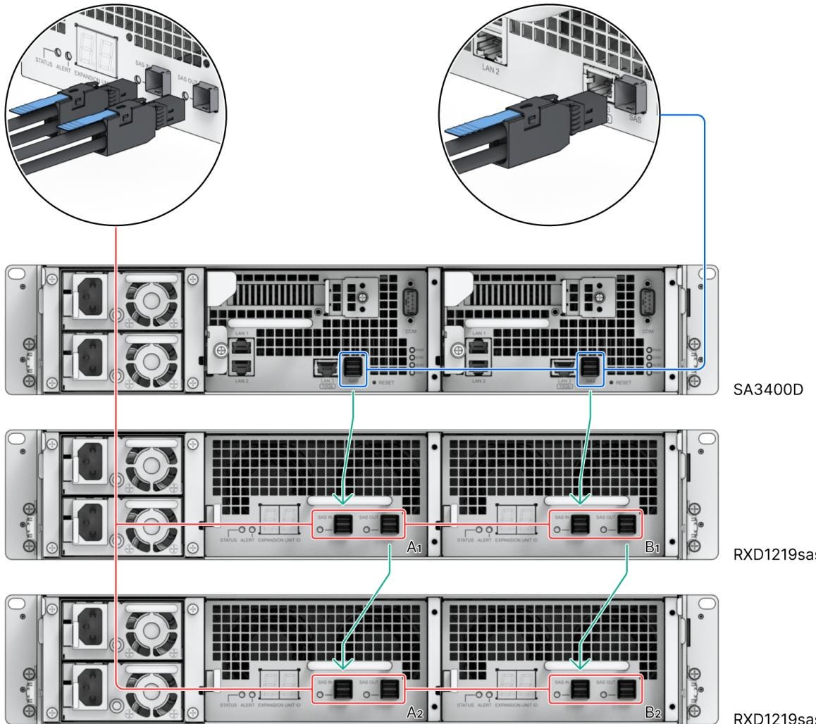
2. 将电源线接到 RXD1219sas 的电源端口，另一端接到电源插座。
