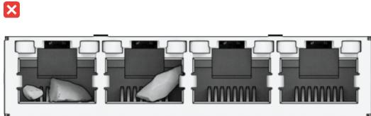
6. 检查网络端口内部是否有损坏或歪斜的针脚。
