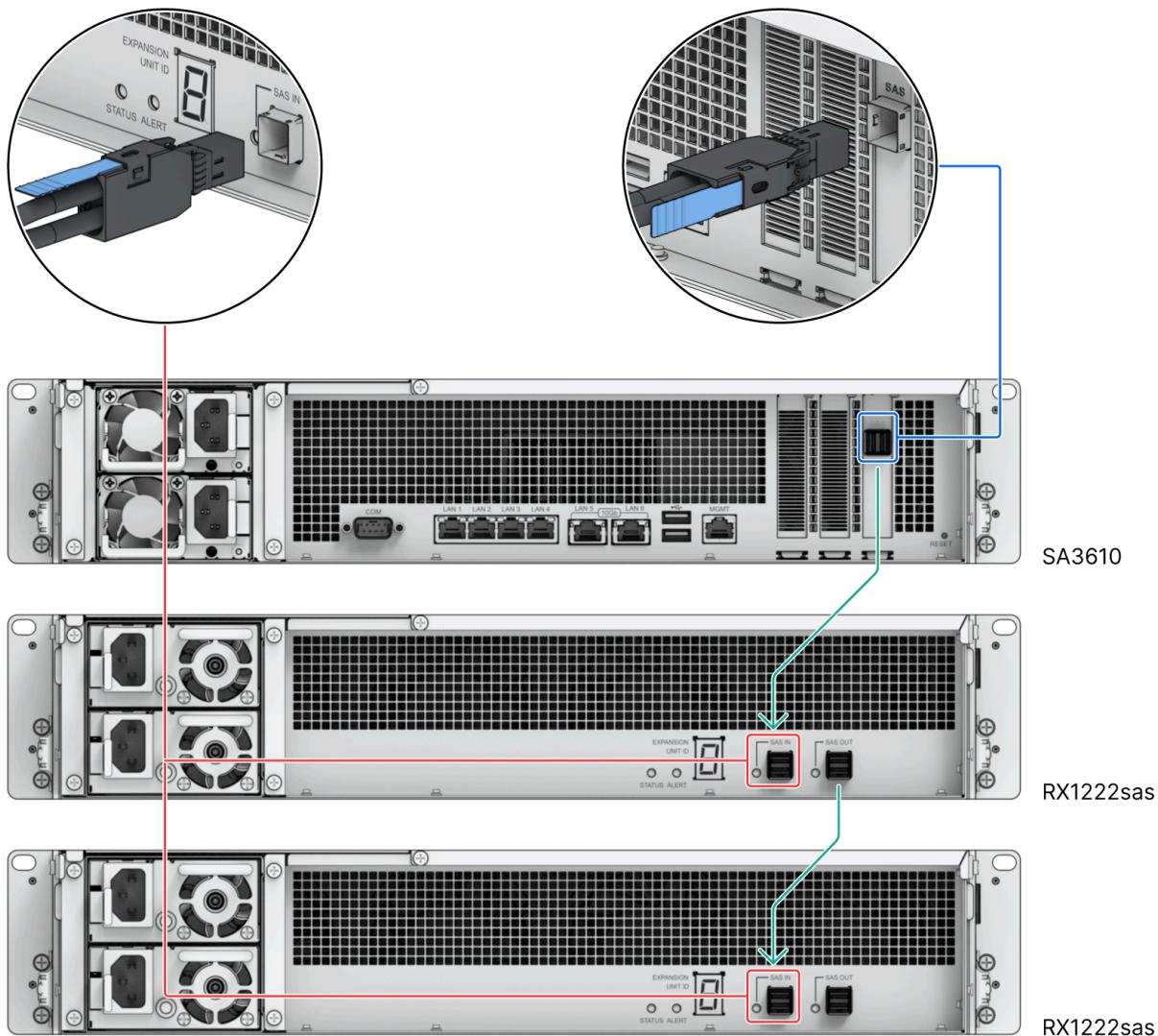
2. 将电源线接到 RX1222sas 的电源端口，另一端接到电源插座。
