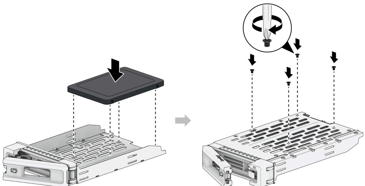
4. 对于 3.5 英寸硬盘：将硬盘置于硬盘托盘中。将托盘翻转朝下，然后拧紧螺丝来将硬盘固定到位。
