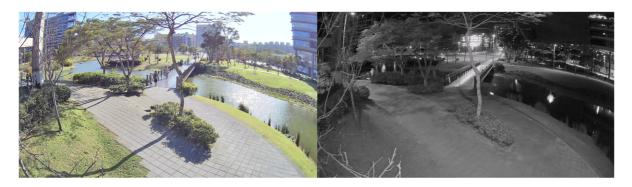
您还可以选择**自动**并指定摄像机切换模式时的照度阈值 (lux)。这会根据一天中不同时间的可用光量自动调整摄像机的设置。在设置中,您可以查看目前照度级别,以帮助您确定适当的阈值。
