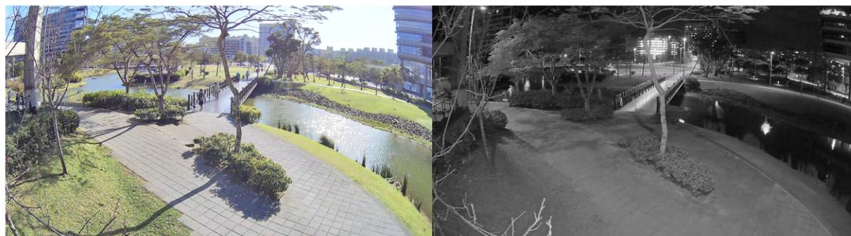
También puede seleccionar **Automático** y especificar un umbral de iluminancia (lux) en el que la cámara debe cambiar de modo. Esto ajustará automáticamente la configuración de la cámara en función de la cantidad de luz disponible en varios momentos del día. En la configuración, puede ver el nivel de iluminancia actual para ayudarle a decidir un umbral adecuado.
